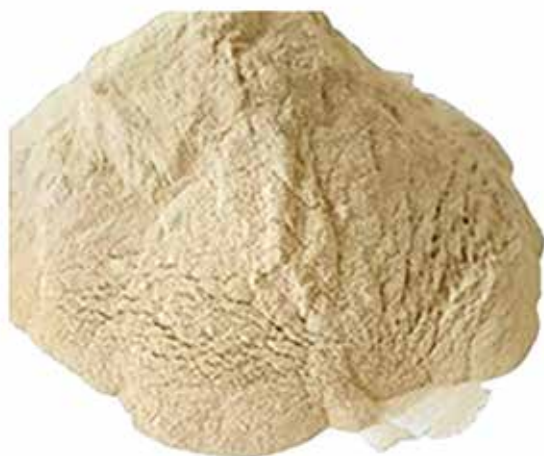
Hình 2. Mẫu bột quặng magnesite sau khi được nghiền khô.
