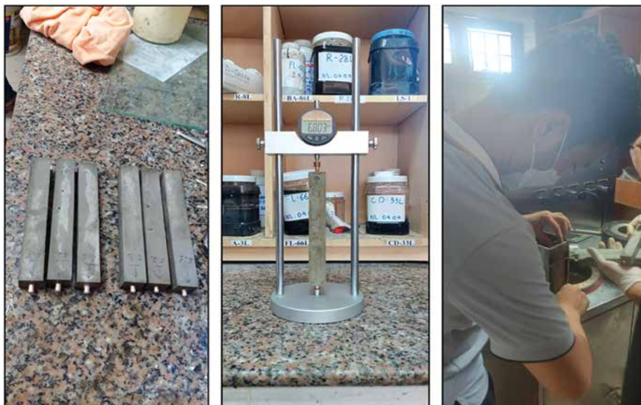
Hình 10. Quá trình lắp mẫu và chạy autoclave đo độ giãn nở ở điều kiện nhiệt độ 160°C, áp suất 210 atm.
